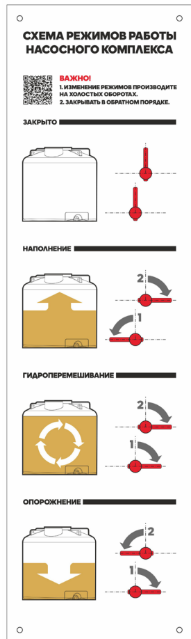
Схема режимов работы насосного комплекса для одной емкости Кассеты TRF
