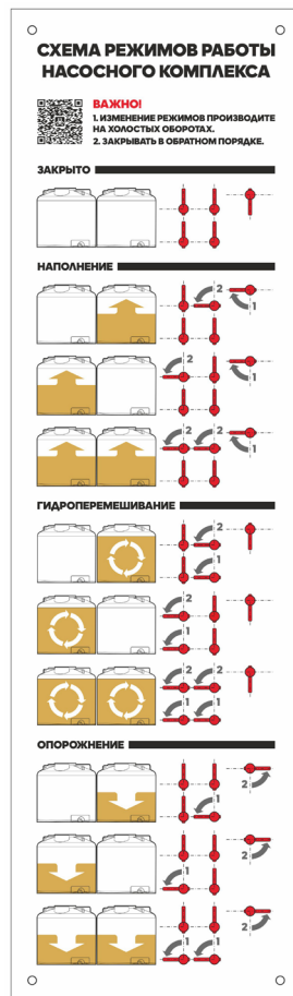
Схема режимов работы насосного комплекса для двух емкостей Кассеты TRF
